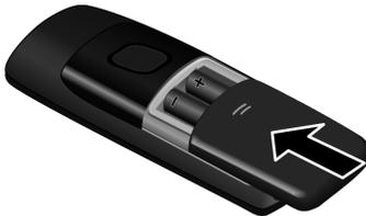
Falls Sie den Akkudeckel wieder öffnen müssen, um z. B. die Akkus zu wechseln, greifen Sie in die Riffelung oben am Deckel und schieben ihn nach unten.
